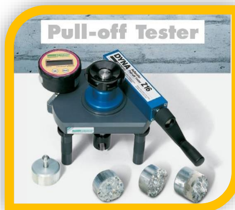
Badanie odporności podłoża na odrywanie metodą pull-off
